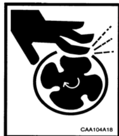
CAA104A18 Fan Blade Caution
